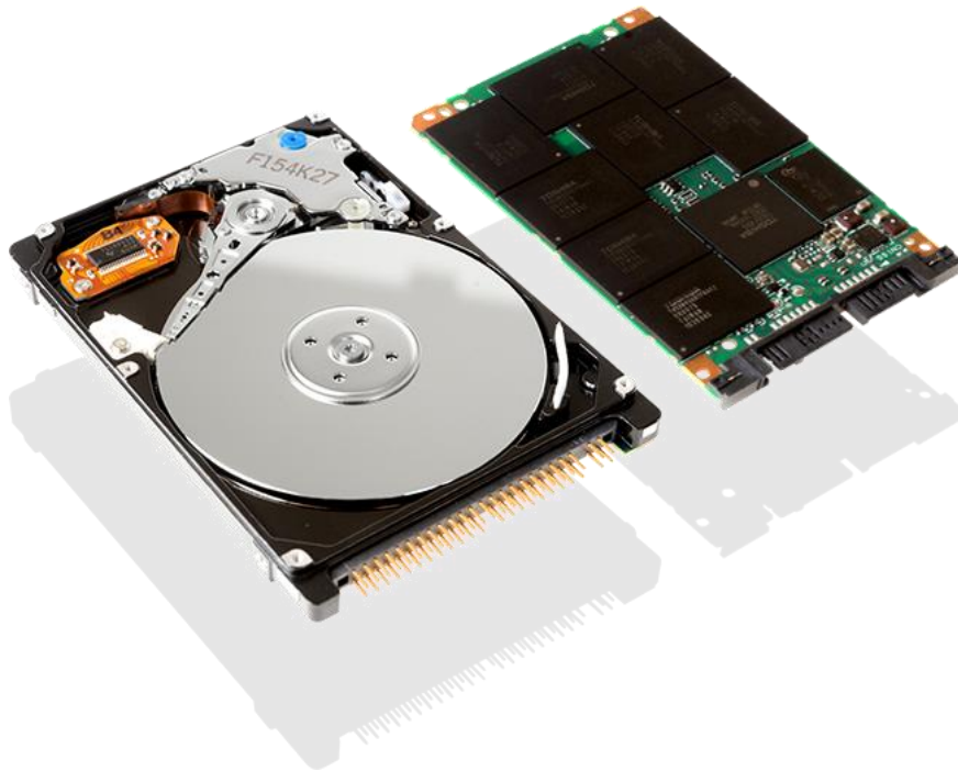
Фигура 5: Нагледно сравнение на дизайна на SSD и HDD
